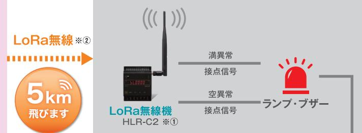
※① HLR-C2:接点2点入出力 ペアで使えば接点無線送信可能！
