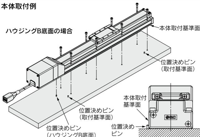
本体取付基準面は走り平行度の基準面となっております。テーブルの走り平行度が必要な場合は基準面を平行ピンなどに押当てて設置してください。
