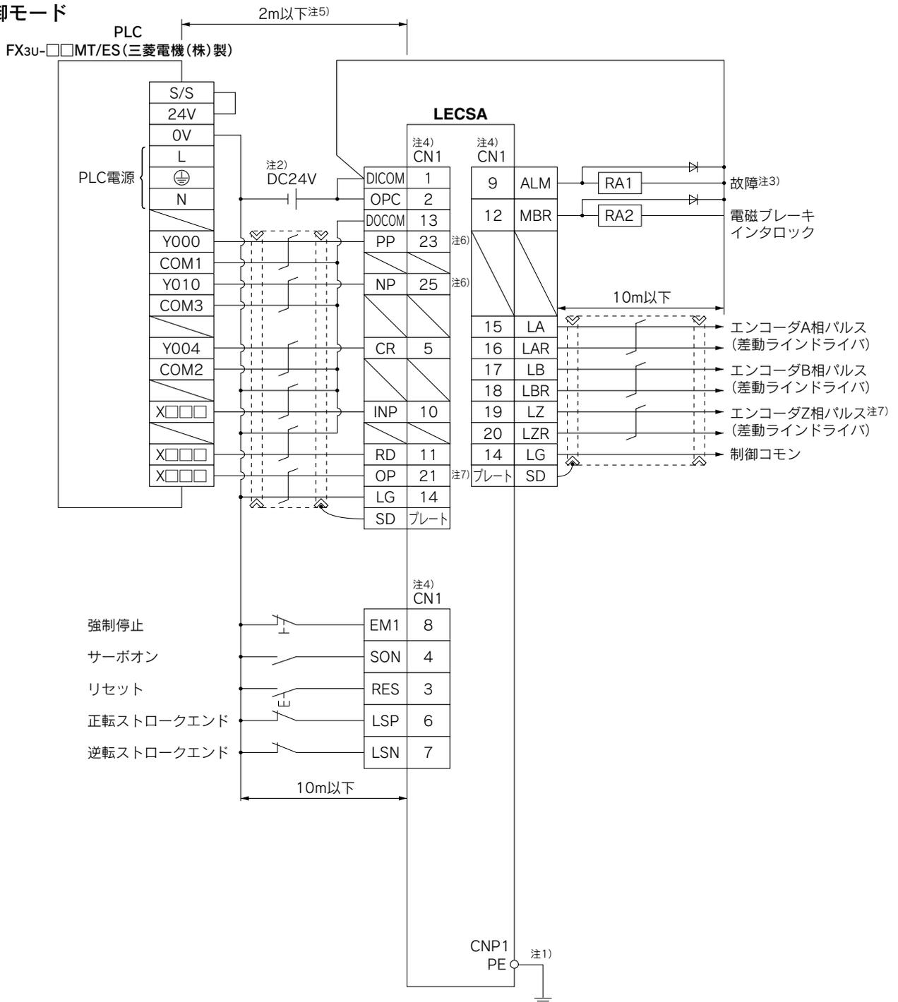
注1) 感電防止のため、ドライバ主回路電源コネクタ(CNP1)の保護アース(PE)端子(⊖マークのついた端子)を制御盤の保護アース(PE)に必ず接続してください。
