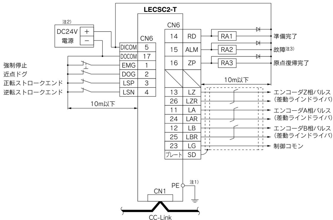
注1) 感電防止のため、ドライバの保護アース(PE)端子(⊕マークのついた端子)を制御盤の保護アース(PE)に必ず接続してください。
