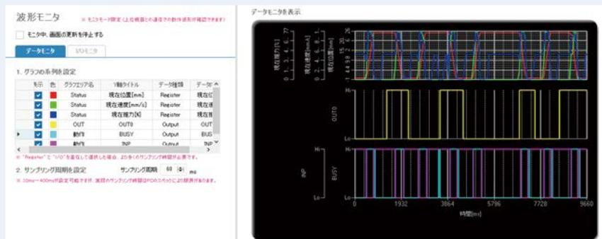
運転中の位置・速度・推力・入出力信号などの波形データが測定できます。
