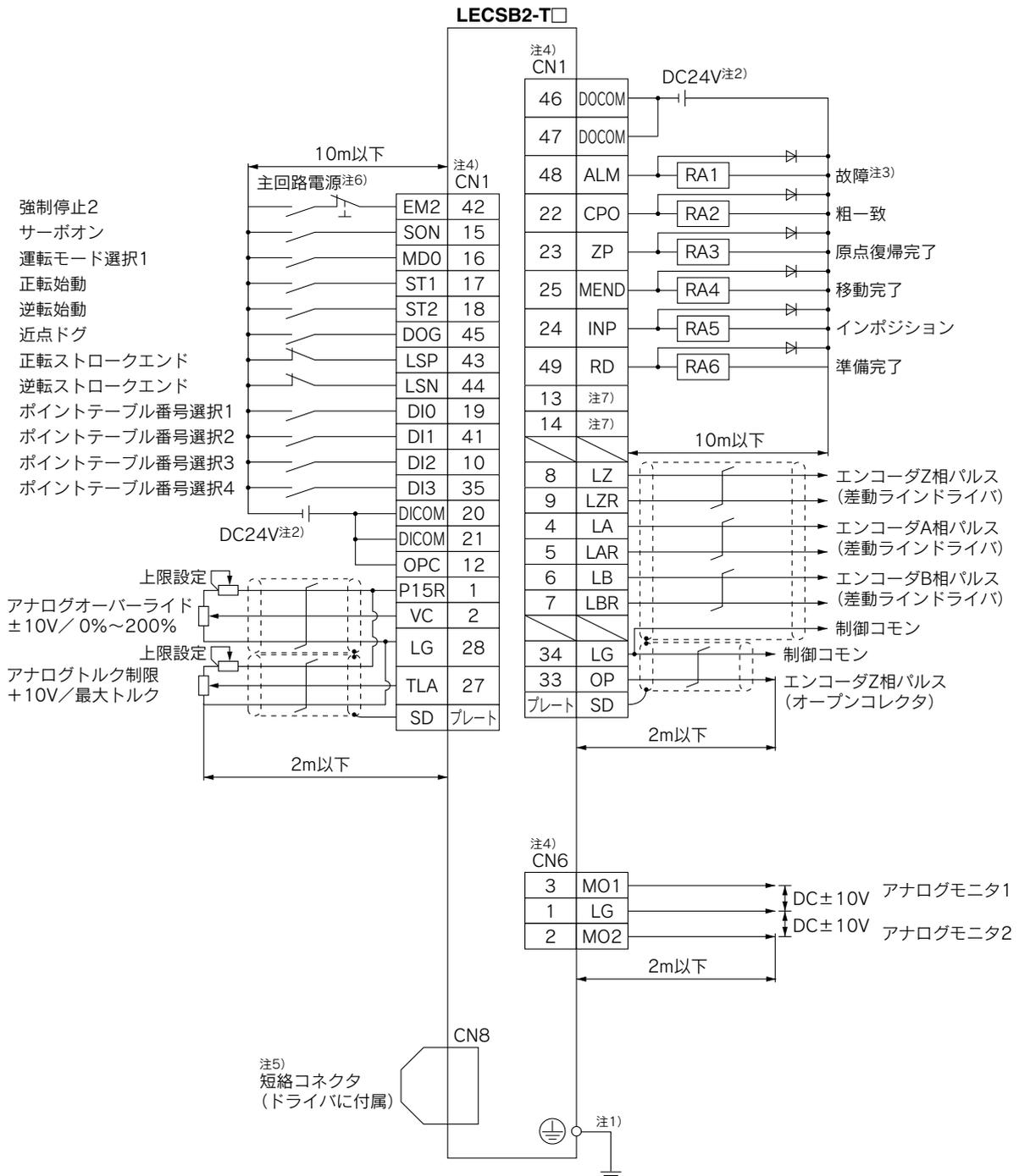
注1) 感電防止のため、サーボアンプの保護接地(PE)端子(⊕マークのついた端子)を制御盤の保護接地(PE)に必ず接続してください。
