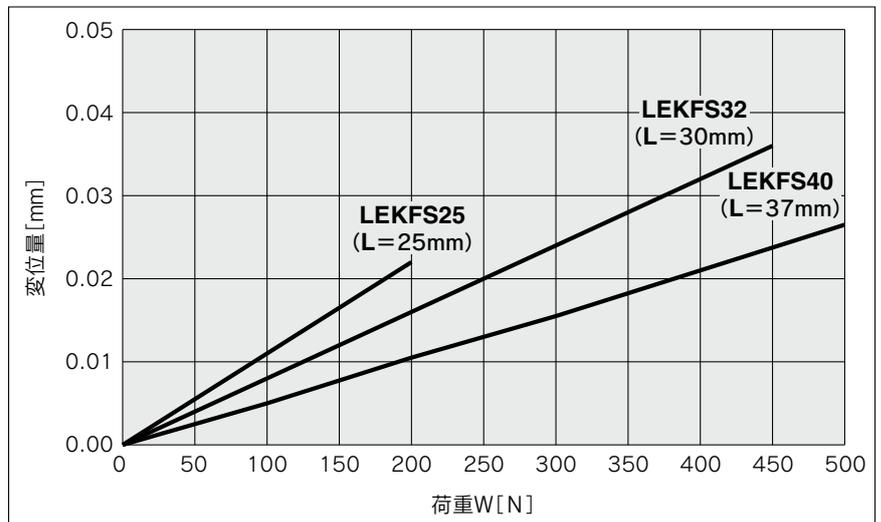
注) アルミ板厚15mmをテーブル上面に固定し測定した時の値です。
