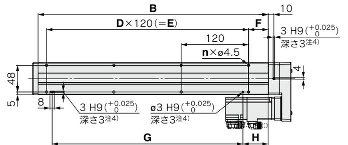
注1) 本体取付基準面を使用して設置される場合には、相手面もしくはピン高さを3mm以上にしてください。(推奨高さ5mm)
