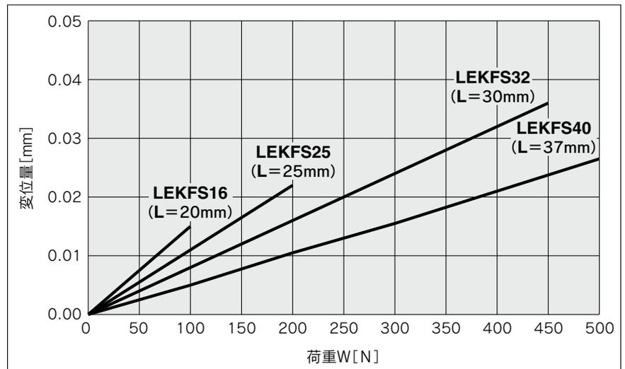
注) アルミ板厚15mmをテーブル上面に固定し測定した時の値です。
